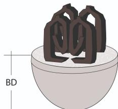
Der Gießbetonabstandhalter hat eine runde Aufstandsfläche. Die Doppelklammer verklammert sich gut an den Bewehrungsstahl. Der Abstandhalter kann sowohl an stehender und an liegender Bewehrung montiert werden. Die Montage ist an Bewehrungs- Ø 6-16 mm möglich.
