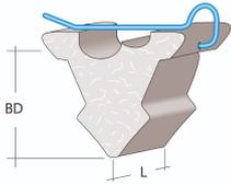
Der Kapo wird überwiegend an stehender Bewehrung montiert. Die Montage ist an Bewehrungs-  $\varnothing$  3-10 mm möglich. Um ein Verdrehen zu vermeiden, wird der Kapo auf einem Bewehrungskreuzungspunkt montiert. Die Federstahlklammer  $\varnothing$  2 mm verklammert den Kapo optimal an dem Betonstahl. Eine schnelle Montage ist gewährleistet. Durch die geringe Auflagefläche erzielt man eine sehr gute Sichtbetonoberfläche. Auf Wunsch kann der Beton auch in anderen Farbtönen geliefert werden.
