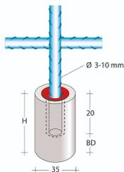
Der BWA wird am Ende der Bewehrung montiert. Die Montage ist an Bewehrungs-  $\varnothing$  3-10 mm möglich. Die Kunststoffklammer sorgt für einen sicheren Halt. Die Einstecktiefe liegt bei 20 mm.
