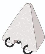
Die Roka-P Pyramide wird an stehender Bewehrung montiert. Die zwei Federstahlklammern Ø 2 mm verklammern die Pyramide optimal an dem Betonstahl. Eine schnelle Montage ist gewährleistet. Durch die punktförmige Aufstandsfläche erzielt man eine sehr gute Sichtbetonoberfläche. Die Nut -Breite und -Tiefe wird gemäß dem Bedarf hergestellt.
