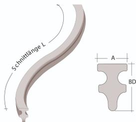
Der Aal 20/50 ist ein Flächenabstandhalter und wird im Bereich von Bodenplatten bei liegender Bewehrung eingesetzt. Die Aufstandsfläche ist ungenoppt und stabil. Durch die zwei Biegungen ist er kipp- und lagesicher. Eine schnelle Montage ist garantiert.
