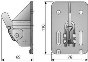
Verstärktes Spannschloss, verzinkt, mit Feder. Für Spanndraht von 5 bis 10 mm. Maximale Belastung 10 kN für Ø 10 mm nach DIN 18216.
