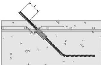
Bestehend aus Blechstreifen und Kunststoffaufnahme für Verankerungshilfen für einhäufige Wandschalungen. Zum Einbau von Ankerstäben, Verankerungsschlaufen, Wellenanker, Schlaufenhaken etc. unter 45° Neigung.
