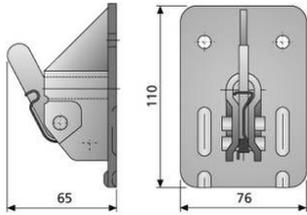
Verstärktes Spannschloss, verzinkt, mit Feder. Für Spanndraht von 5 bis 10 mm.
