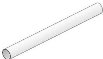
Distanzrohre aus Stahl sind besonders zu empfehlen bei großen Wanddicken und im Grundwasserbereich mit aufgeschweißten Wassersperren.
