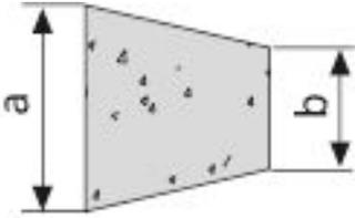
Zum Verschließen von Kegellöchern. Wird mit 2-Komponenten-Kleber oder Beton-Kleber eingeklebt. 1 kg 2-Komponenten-Kleber reicht für ca. 60 Betonstopfen.
