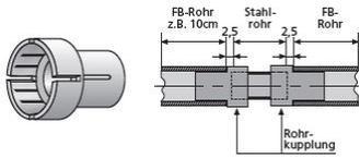
Verbindungsstück aus Kunststoff für Distanzrohr Stahl 22 mit Distanzrohr FB 22.
