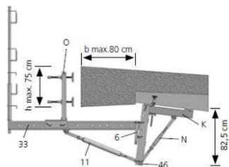
Für weit auskragende Kappengesimse im Brückenbau.
