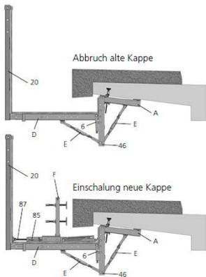
Neue Sanierungskonsole mit Sanierungsriegel.
