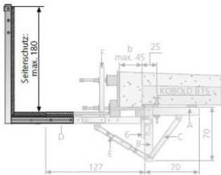
Zusatzkomponente zum GK-2000-System alternativ zum BX-Geländerpfosten als vollflächig beplankbare Absturzsicherung über bzw. an unter Verkehr stehenden Bauwerken, z.B. elektrischen Bahntrassen und Autobahnen.
