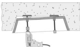
Mit dem KNACKER® lassen sich auch komplizierte oder besonders fest haftende Schalelemente leicht lösen. Der gehärtete Deckel ermöglicht den mehrfachen Einsatz des KNACKER®s.
