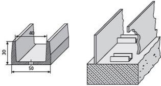
Distanzprofil mit Nagellöchern zum Ausrichten und Ansetzen von Wandschalelementen. Statt Holzlatten, die aufquellen und später verrotten. Um Wasserrumläufigkeit zu vermeiden, Basisleiste nicht über die ganze Breite, sondern versetzt anordnen.
